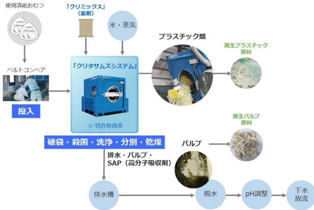
図 2-4 洗浄・分離処理によるパルプ・プラスチック回収と熱回収の流れ 6
