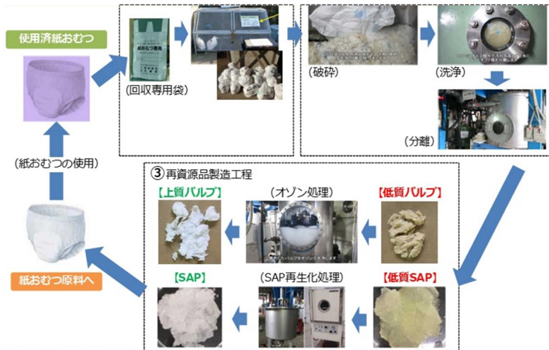
図 2-3 水溶化・分離・オゾン処理による水平リサイクルに向けたパルプ回収の流れ 5
